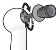
※ノズルが本体にセットされていないとスピнкаップ・スピントップが空回りします。
