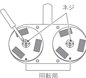
② 10箇所のネジをプラスドライバーで取り外す。
